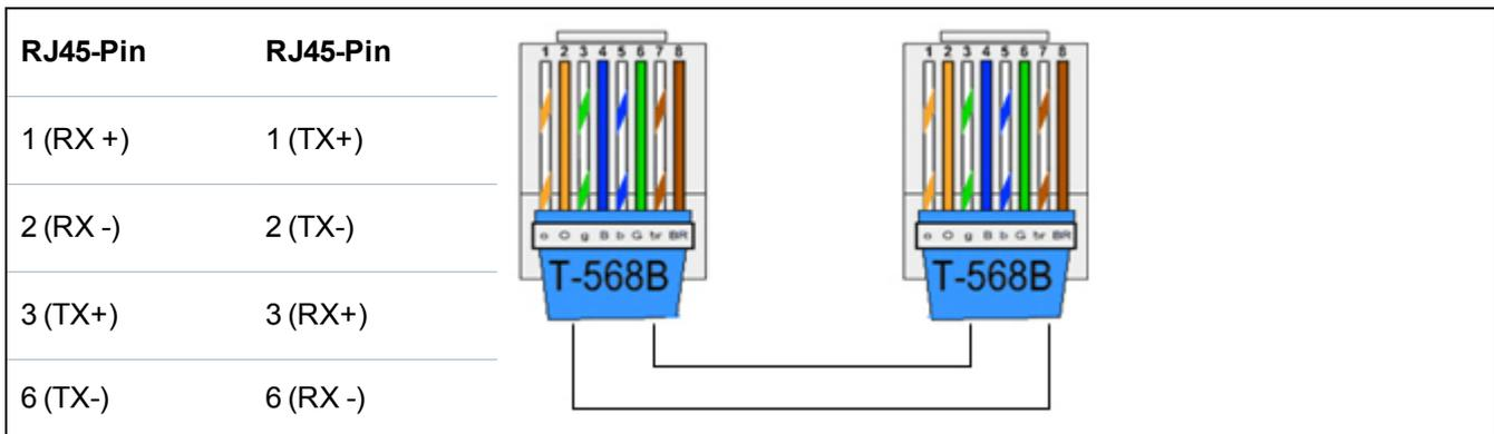
Verwenden Sie das Kreuzkabel, um die SPC-Zentrale direkt an einen PC anzuschließen.
