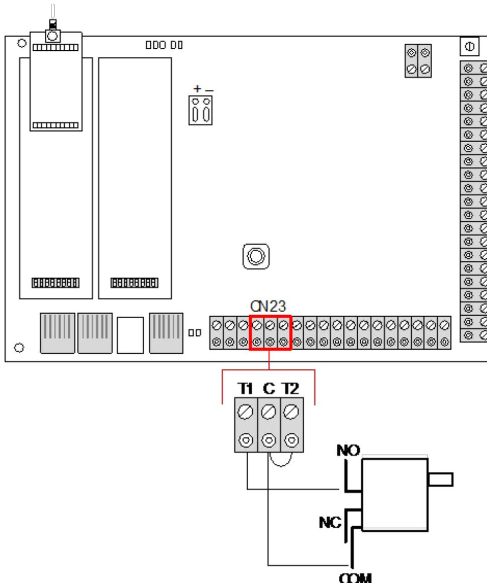
1. Verbinden Sie den Schließer (NO) am Sabotagekontakt mit dem Anschluss T1 auf der Zentrale.
