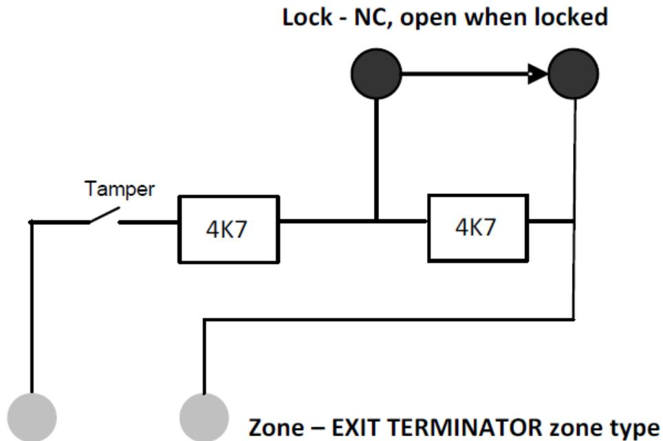
Für SPC muss der MG-Typ ABBRUCH SCHARFSCHALTUNGSVERZÖGERUNG konfiguriert werden.
