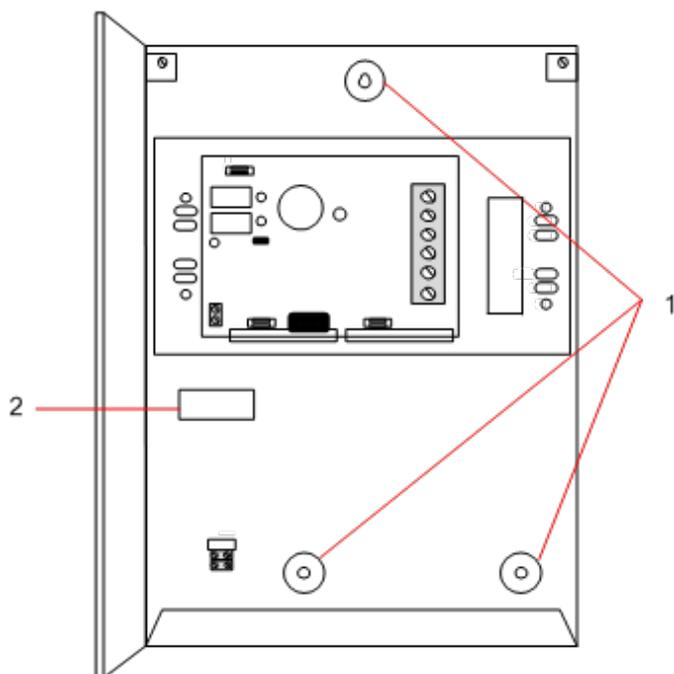
Befestigung des Gehäuses an der Wand:
