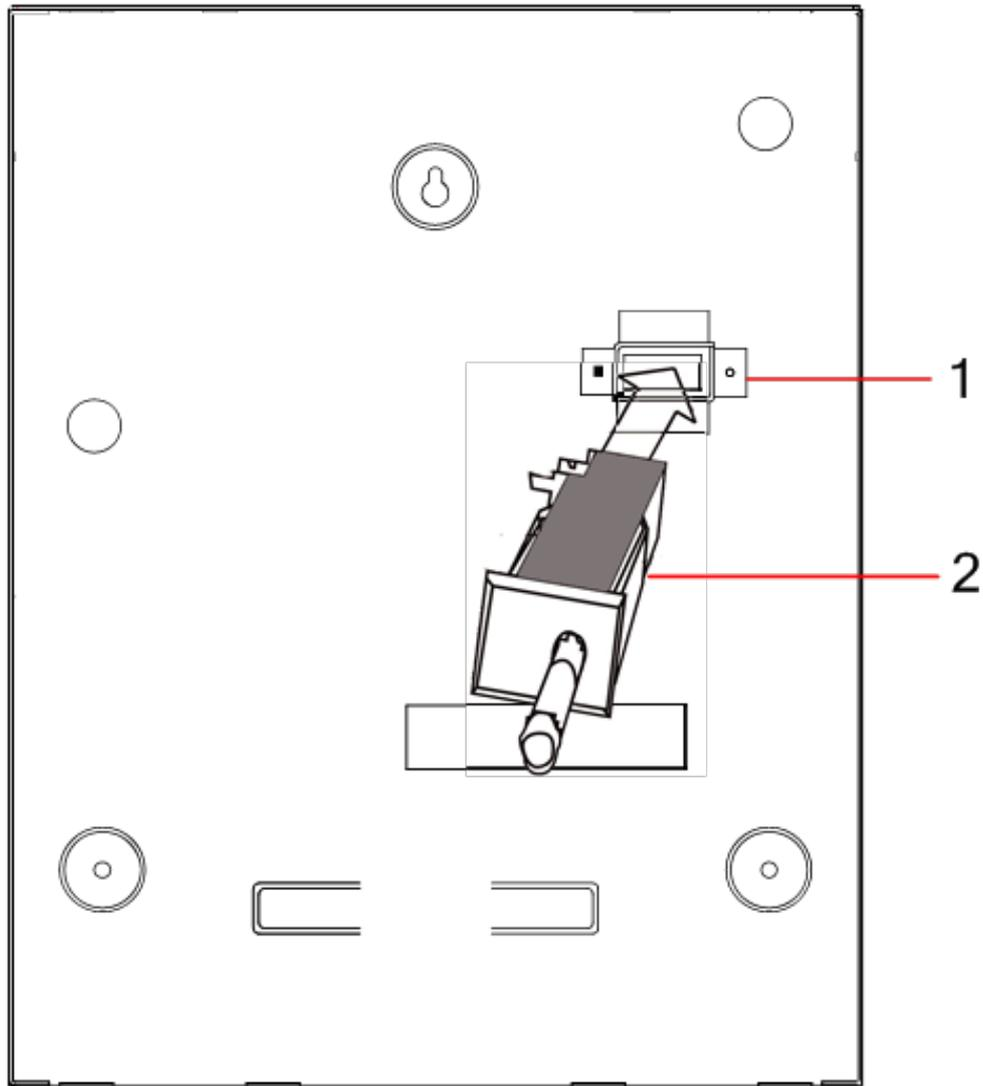
2. Setzen Sie das Gehäuse wieder auf die Wand. Verwenden Sie hierzu die drei zuvor entfernten Halterungen (siehe Pos. 2 nachfolgend). Stellen Sie sicher, dass das Gehäuse rundum ohne Zwischenraum auf der Wandplatte aufliegt.
