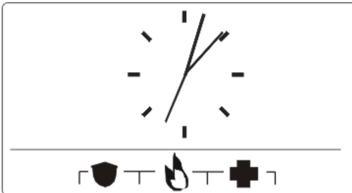
Je nach Konfiguration werden Notfalltasten angezeigt. Das gleichzeitige Drücken der Tasten aktiviert einen Alarm bzw. Notruf.
