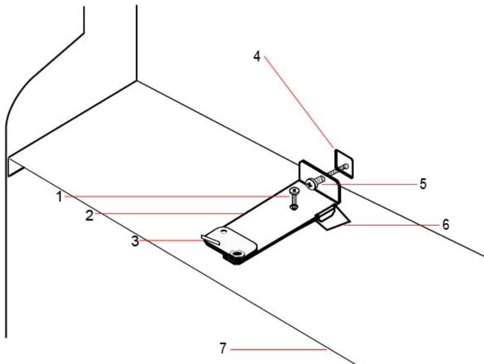
6. Bringen Sie den Deckel auf dem Gehäuse an, um den Anschluss des Sabotagekontakts zu überprüfen. Öffnen Sie den Deckel etwa 1 mm, um den Sabotagekontakt auszulösen.
