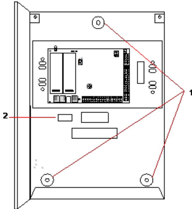
2. Ziehen Sie eine Linie um das Innere des hinteren Sabotagekontakt-Ausschnitts (siehe Pos. 2 vorstehend), um einen Bezugspunkt für die Anbringung der Wandplatte zu erhalten. Entfernen Sie das Gehäuse von der Wand.
