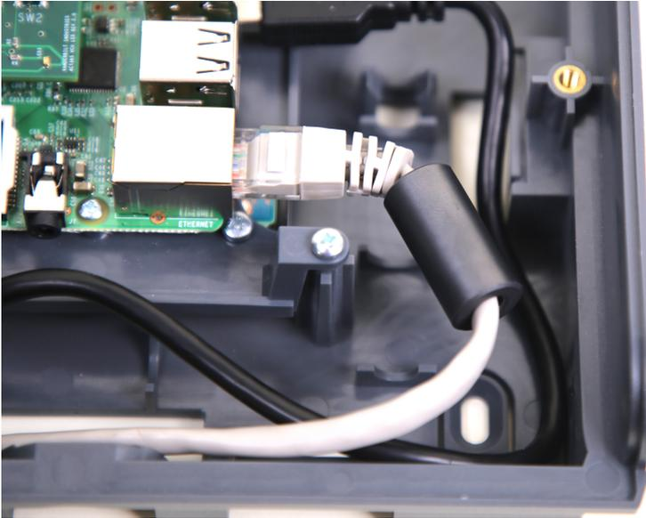
2. Sobald die Ferritperle in Position ist, crimpen Sie das Ethernet-Kabel am Abschlussende.
